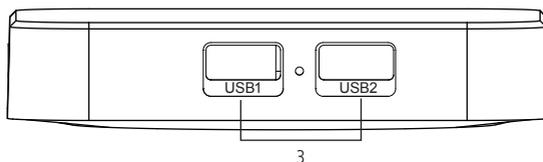
3. Entradas USB (para conexão de periféricos - mouse, teclado, e outros - ou dispositivos de armazenamento).
